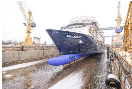
Das Dock wird geflutet und die Mein Schiff 7 hat erstmals Seewasser unterm Kiel.
